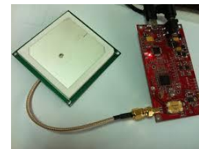
Antenne et lecteur RFID
