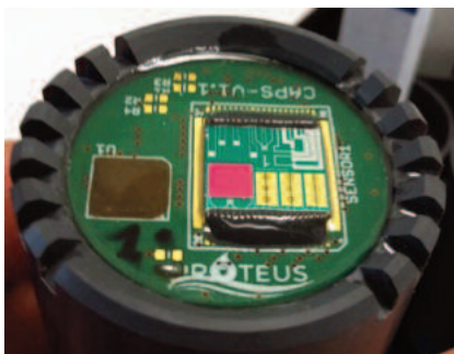
Capteur Proteus multiparamètre avec son électronique de lecture intégrée par puce CMOS
